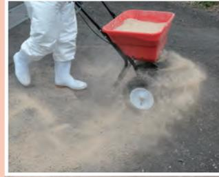
手元のアジャスタハンドルで散布量を調整し、散布します。
